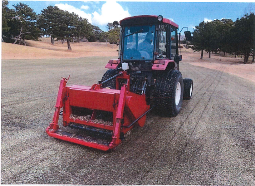
グランドブレイカー作業 傾斜に沿って切れ込みを入れる
