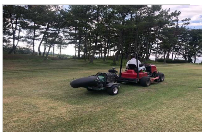
ラフ刈後清掃(タービンブロー)
